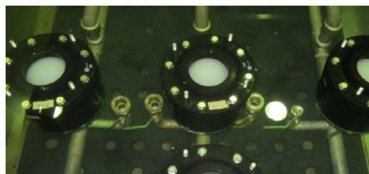
脈動試験状況(水中) φ150mm
