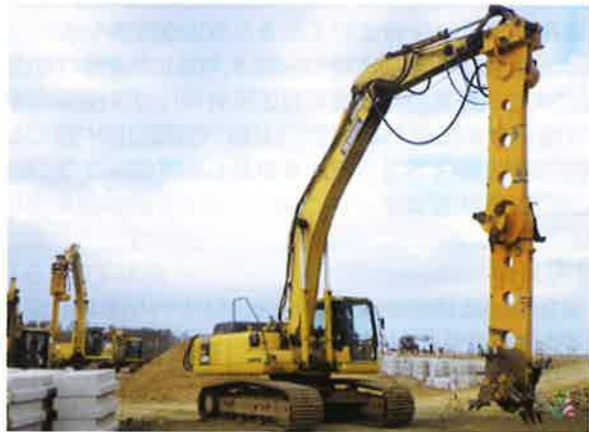
写真-1 SCM施工機（ロータリーブレンダー方式）
