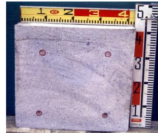
枠断面の状態
