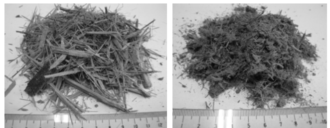
写真-1 膨軟化処理を施していない竹チップ（左）と、膨軟化竹チップ（右）
