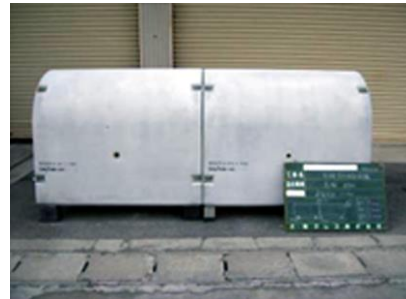
継ぎ目のフレキシブル性を確認
