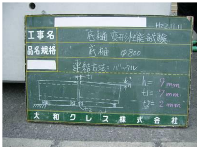
継ぎ目のフレキシブル性を確認
