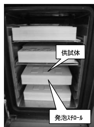
写真-2 低温養生状況
