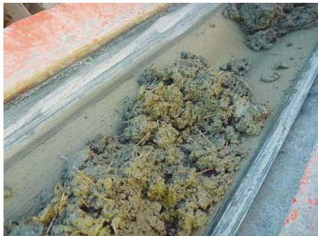
写真-5 モルタル中にBCファイバーが分散
