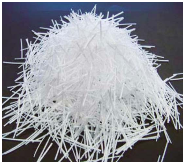
写真-2 汎用湿式吹付方式で施工可能な有機繊維「BCファイバー」
