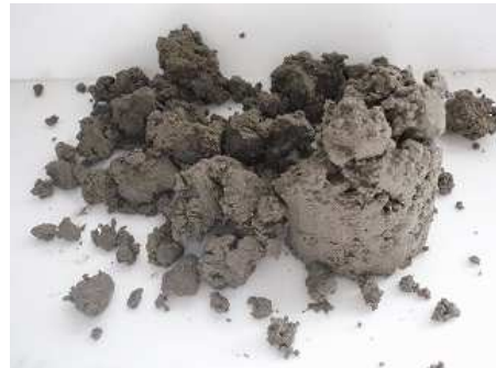
非エア系配合解凍後 崩壊
