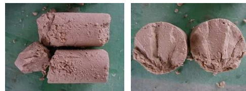
解凍後供試体(非エア系) アイスレンズ融解、供試体崩壊
