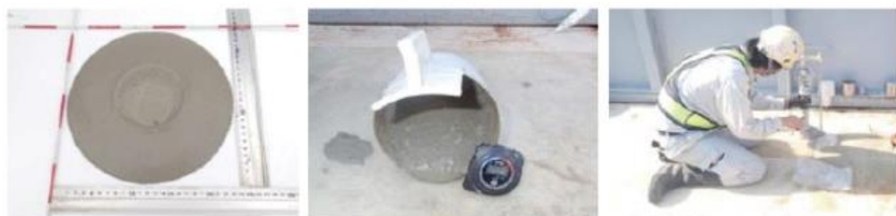
B) 裏込め材料試験(フロー値、ゲルタイム、一軸圧縮試験)
