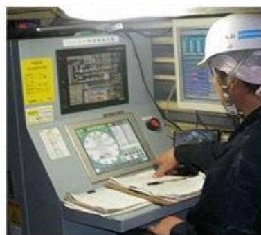
写真-2 シールドオペレータによる自動裏込め注入と管理データ一例
