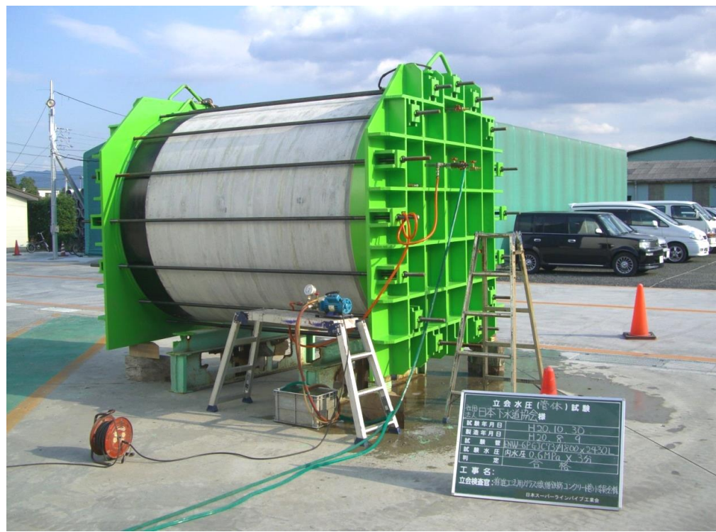
内水圧試験状況
