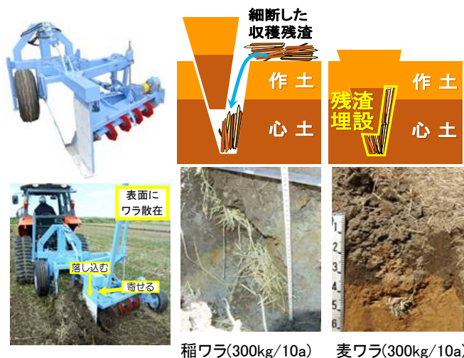
図1 カットソイラーの外観・施工方法及び資材埋設状況
