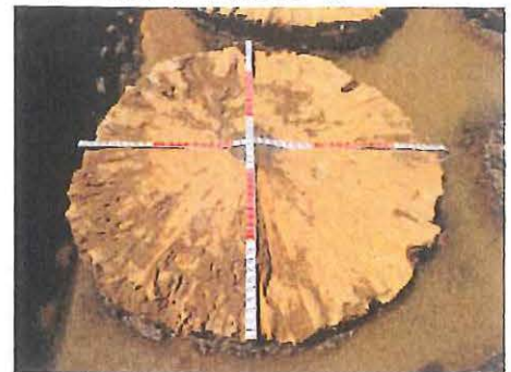
写真-1 改良体出来形 (砂地盤)
