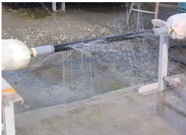
写真-1 従来型注入管の気中吐出状況
