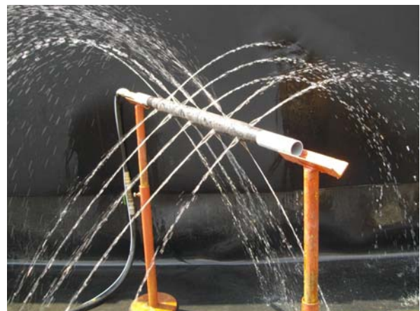
写真-2 新型注入管の気中吐出状況
