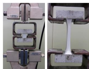
H型試験体による引張接着性試験 (左：初期状態 / 右：最大荷重時)
