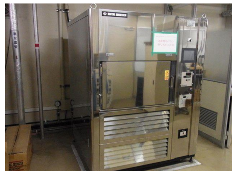
促進耐候性試験機 (メタルハイドランプ方式試験機)
