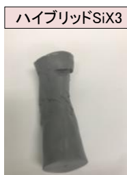
5°C, 3日 全体が固化 (ゴム状硬化物)
