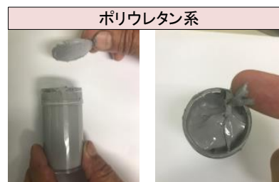
5°C, 3日 表層 2mmまでは硬化。 内部は未硬化。 養生後の内部硬化状況
