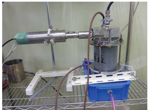
図-1 実験状況 (目詰まりの解消実験)
