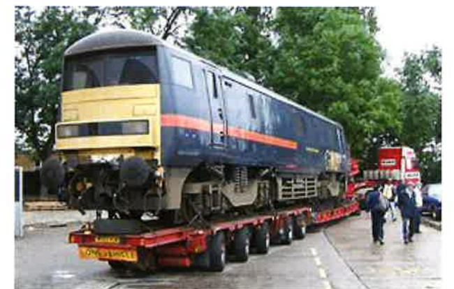
写真-7 低床多軸型トレーラーの事例 11)
