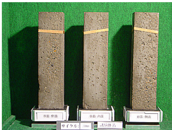
写真-2 含浸材A(300サイクル終了時)状況
