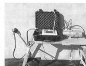
写真-6 表層透気試験(施工後)
